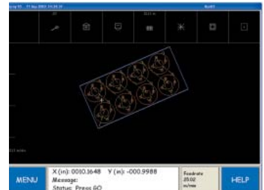
Alinhamento da chapa
