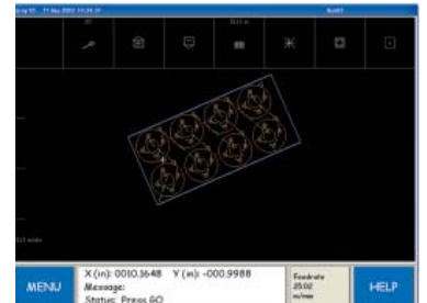
Alignement de la tôle
